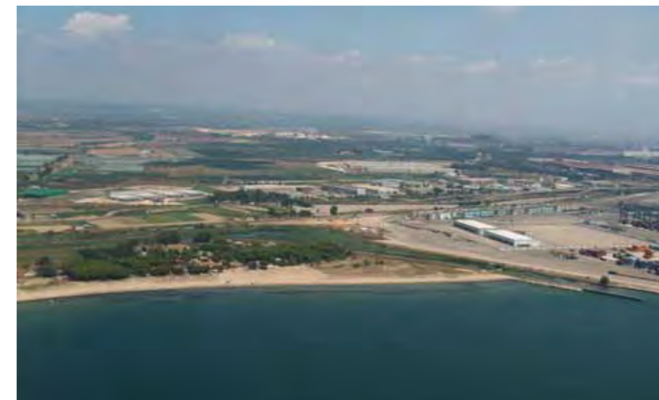
Il molo polivalente del nuovo porto intercetta il flusso di sedimenti long-shore, creando un importante accumulo in corrispondenza della foce armata del fiume Tara
