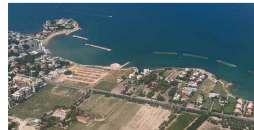
Capo Colonna ad est di Trani, sistema di barriere frangiflutti costruito per contrastare il fenomeno di erosione costiera
